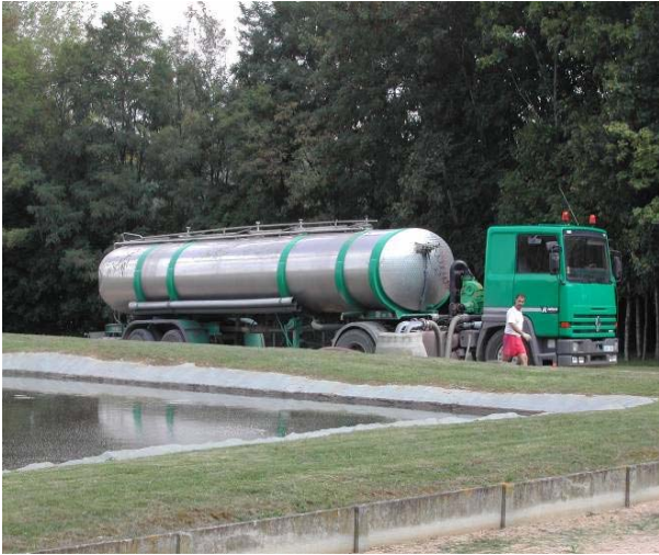
photo1 : camion de transfert des boues liquides
