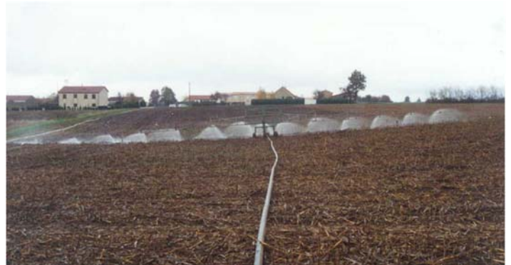
photo 7 : Rampe basse- équipée reliée à un enrouleur
